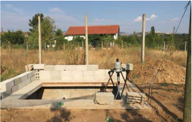
Слика 34. Фертиригатор со контролна единица во насад со Круша (Младо Нагоричане)
