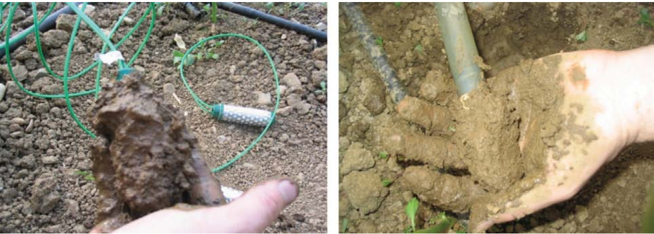
Слика 11 - Воспоставување контакт помеѓу сензорот за влага, односно керамичкиот врв на тензиометарот со почвата
