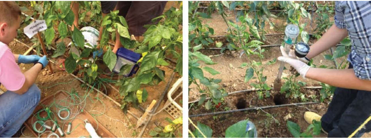
Слика 12 - Инсталирање на сензорите за влага со дата логерот и со тензиометрите на постојано место
