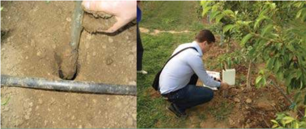
Слика 36 . Поставување тензиометар и сензори за влага на постојано место во насад со круша во Младо Нагоричане
